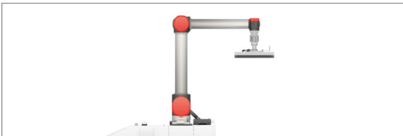
图 1-14 机器人工作零点位置图
