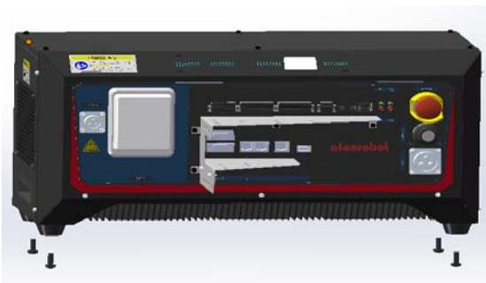
1.拆下固定柜体脚垫的十字螺丝
